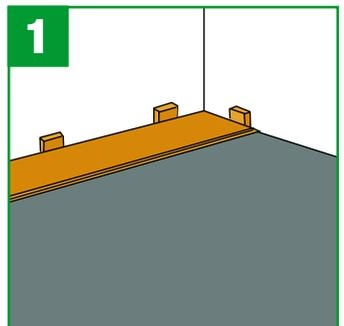
Benutzen Sie ausreichend Holzkeile, um die Dehnungsfuge während der Verlegung zu fixieren. Es ist zu empfehlen, die Dielen längs zum Lichteinfall zu verlegen. Ferner sollten Sie an einer geraden Wand des Raumes beginnen.
