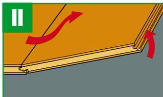
Benutzen Sie ausreichend Holzkeile, um die Dehnungsfuge während der Verlegung zu fixieren. Es ist zu empfehlen, die Dielen längs zum Lichteinfall zu verlegen. Ferner sollten Sie an einer geraden Wand des Raumes beginnen.
