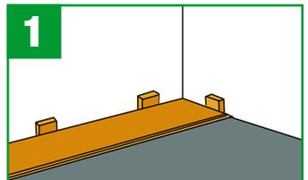
Benutzen Sie ausreichend Holzkeile, um die Dehnungsfuge während der Verlegung zu fixieren. Es ist zu empfehlen, die Dielen längs zum Hauptlichteinfall zu verlegen, in länglichen, schmalen Räumen ist immer eine längsseitige Verlegerichtung empfehlenswert. Ferner sollten Sie an einer geraden Wand des Raumes beginnen.
