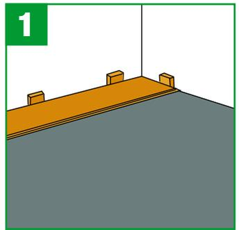
Benutzen Sie ausreichend Holzkeile, um die Dehnungsfuge während der Verlegung zu fixieren. Es ist zu empfehlen, die Dielen längs zum Hauptlichteinfall zu verlegen, in länglichen, schmalen Räumen ist immer eine längsseitige Verlegerichtung empfehlenswert. Ferner sollten Sie an einer geraden Wand des Raumes beginnen.
