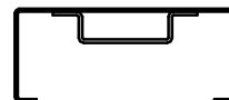
Befestigung mit Hutanker fissaggio con staffa ad "U" fitting with "U" bracket
