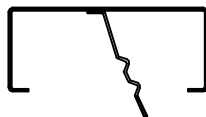
Befestigung mit Maueranker fissaggio con zanca a muro fitting with anchor for concrete
