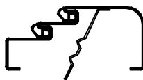
Befestigung mit Maueranker fissaggio con zanca a muro fitting with anchor for concrete
