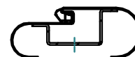
Befestigung mit Hutanker fissaggio con staffa ad "U" fixing with "U" bracket
