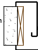
Montage auf Holzblindrahmen montaggio su falso telaio fitting on wooden subframe
